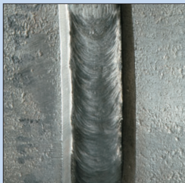
Сварка нержавеющей сталей
