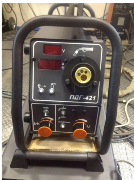
Рис.1. передняя панель обновленного ПДГ-421 с индикацией.
