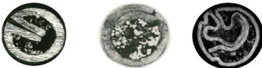
Шовная (вальцованная) порошковая проволока (ЭСАБ, ЛИНКОЛЬН и др.)
