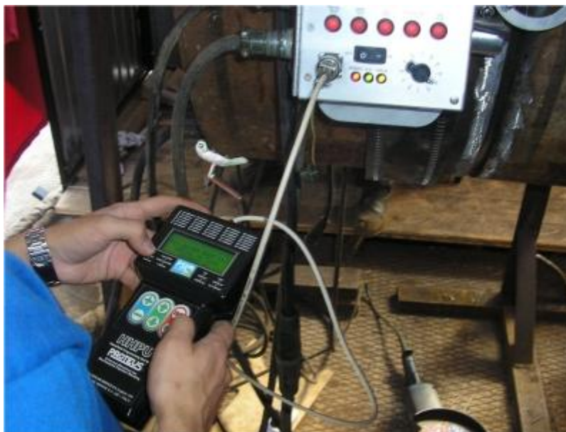
Рис.2 Внешний вид головки «ПРОТЕУС» и процесс программирования головки на 12 каналов.
