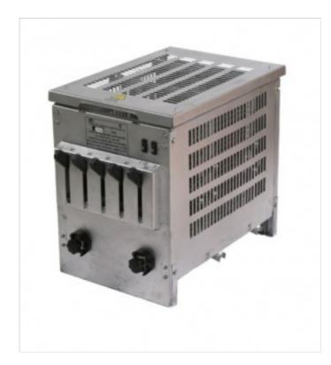
Реостат балластный РБ-302 предназначен для регулирования тока при ручной дуговой сварке и наплавке металлов плавящимся электродом от многопостовых сварочных выпрямителей типа ВДМ, а так же для обеспечения требуемой крутизны внешней вольтамперной характеристики в любых сварочных источниках.
