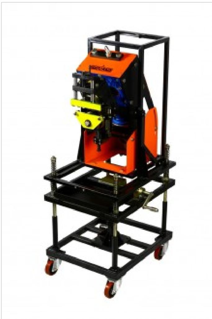
Высокоскоростная кромкоскальвающая машина МКС-21У предназначена для механической разделки кромок сверху и снизу листовых материалов под сварку.
