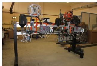
Блок управления предназначен для задания регулируемых режимов цикла сварки, индикации режимов сварки и управления работой автомата в процессе сварки и при наладке.
