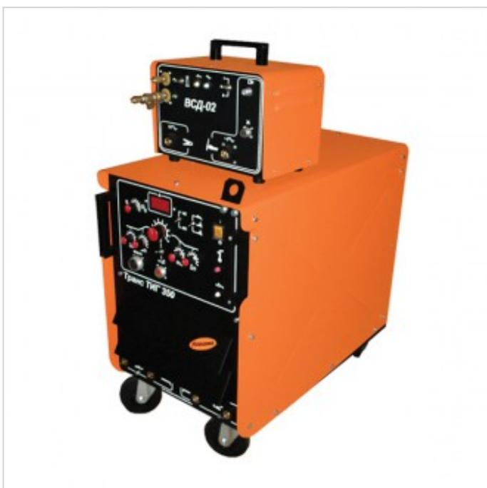
Установка предназначена для аргонодуговой сварки неплавящимся электродом в среде инертных газов (режим ТИГ), а так же для ручной дуговой сварки покрытыми электродами (режим ММА) на переменном (AC) и постоянном (DC) токе всех видов металлов и сплавов. УДГУ-351 AC/DC «Транс ТИГ 350» может быть использована для воздушно-дуговой резки (строжки) угольным электродом в режиме падающей внешней характеристики.
