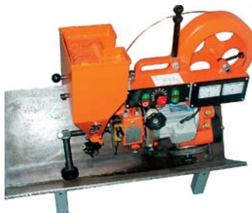
ТС-16, сварка «в лодочку»
