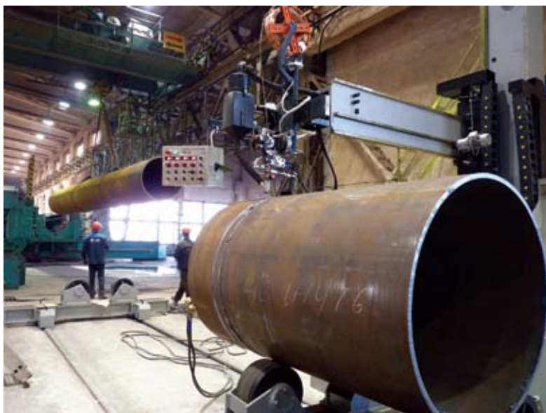
Сварочный комплекс на базе АДФ-1000
