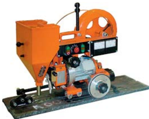
ТС-16, сварка в «разделку» с использованием копира
