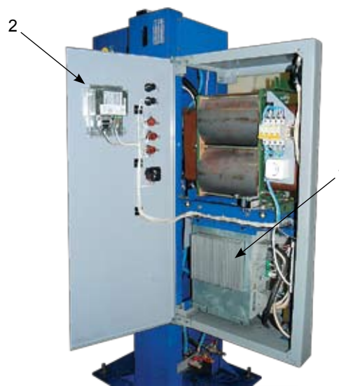
Вид машины MT-1928 (изнутри) с регулятором (1) и панелью управления (2) Bosch Rexroth
