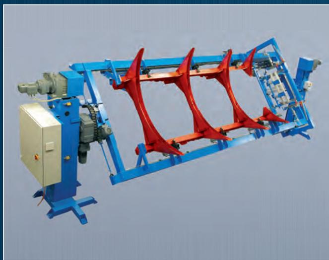
Подъемно-поворотный стол для сварки крупных рамных конструкций
