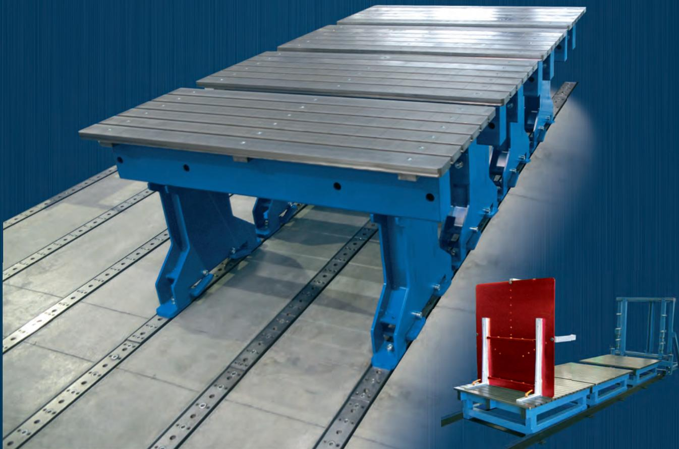
Сварочные столы на выровненных на полу рельсах могут перемещаться в пределах производственного цеха и точно устанавливаться параллельно или один за другим. При этом рельсы крепятся соответствующими установочными болтами к полу.
