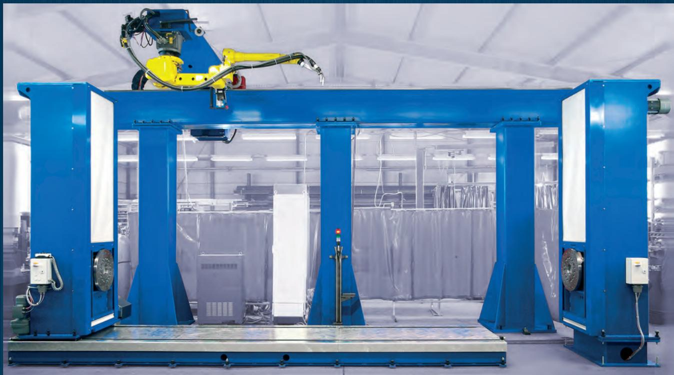
Стандартные сварочные столы с использованием роботов при малых и средних объемах производимых изделий имеет смысл применять только там, где применение стационарных устройств нецелесообразно. При помощи нашей т-пазовой системы мы можем сами быстро изготовить простые устройства и подготовить их (заштифовать) на случай повторных заказов.
