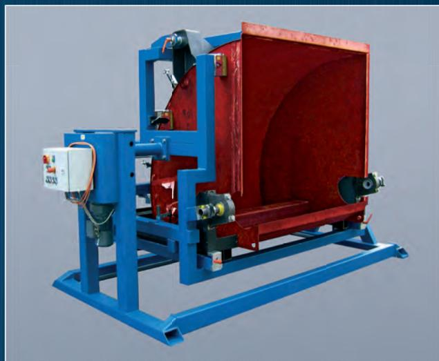
Поворотное устройство для сварки узлов
