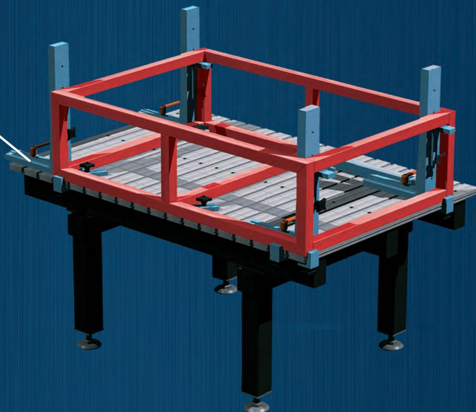
Комплект приспособлений, рекомендуемый для сварки каркасов и корпусов
