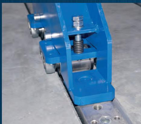
Рельсы на полу могут также использоваться и для крепления другого оборудования и машин.
